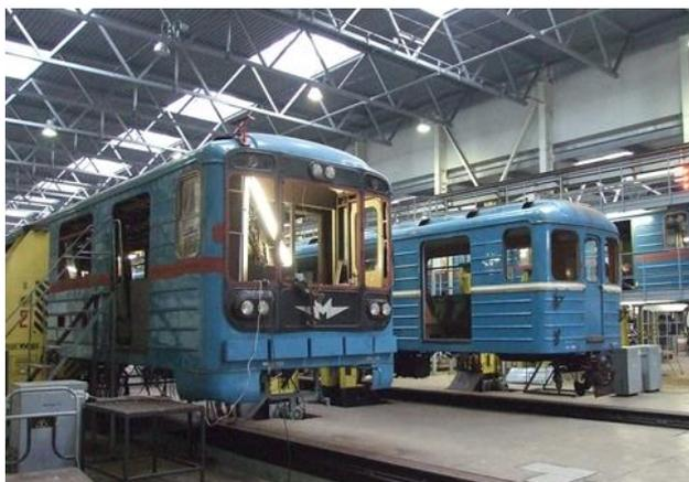
Рис. 1. Головной и промежуточный вагоны на ремонтных позициях
