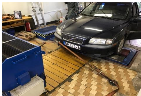
1 pav. Automobilis ant traukos stendo, prijungtas prie ventiliatoriaus, deginių analizatoriaus bei kitos įrangos
